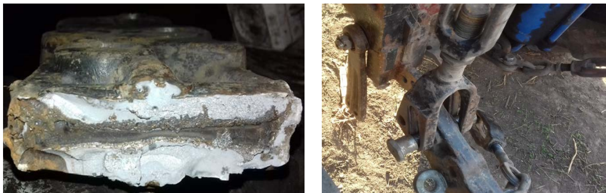
Рис. 4. Хрупкое разрушение продольной тяги навесного устройства
