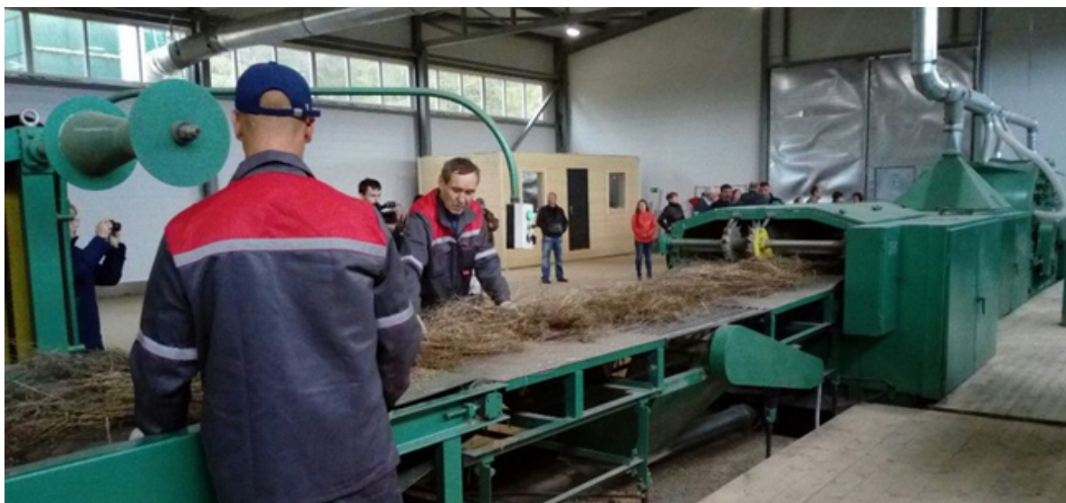
Рис. 3. Линия получения короткого волокна (моноволокна)
