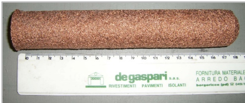
Рис. 2. Фильтроэлементы, изготовленные из МКО методом сухого изостатического прессования: a – цилиндрической формы; б – цилиндрической формы с доньшком
