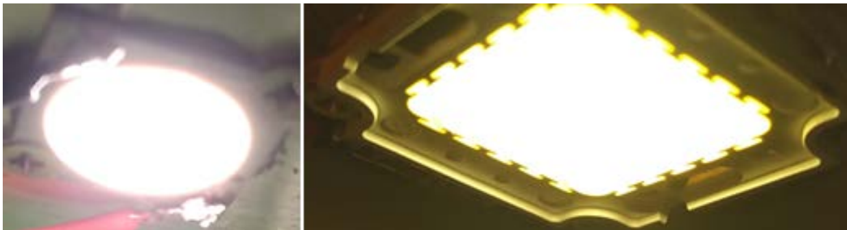
Рис. 4. Экспериментальные светильники со светодиодами 36 ватт.
