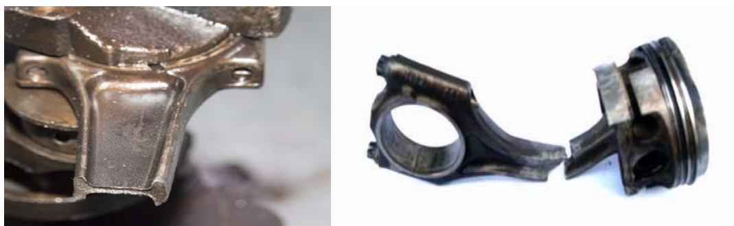
Рис. 2. Вязкое разрушения шатуна двигателя
