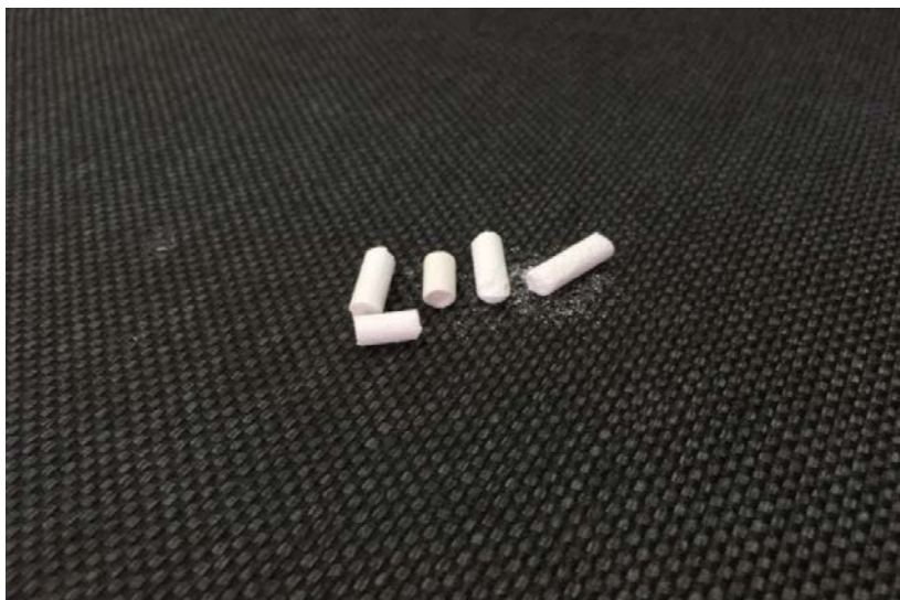
Рис. 3. Цилиндрические таблетки йодистого препарата
