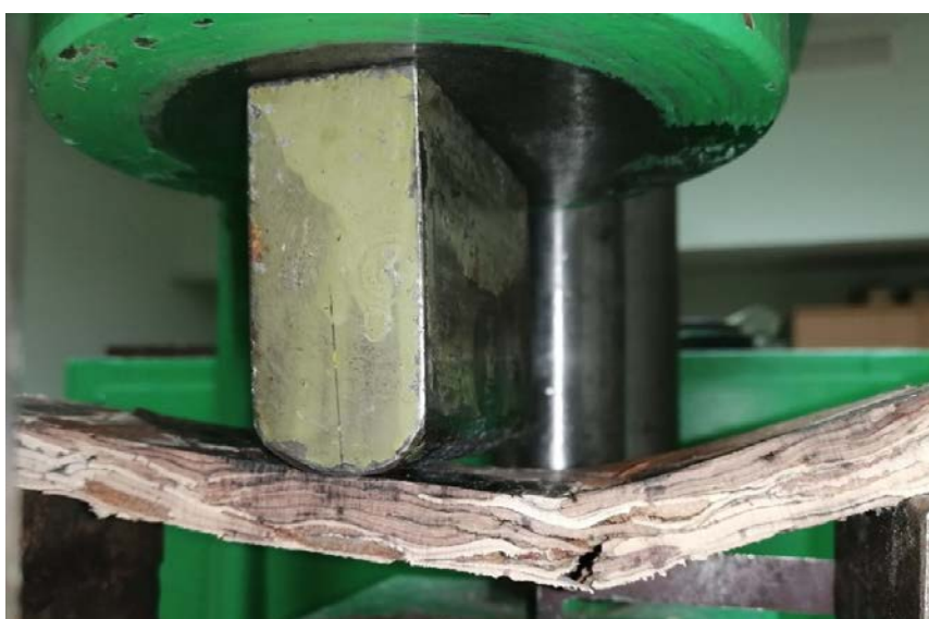
Рис. 2. Испытание образцов плит из березовой коры
