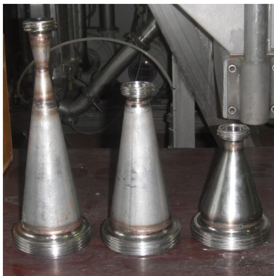
Рис. 2. Сменные конусные камеры
