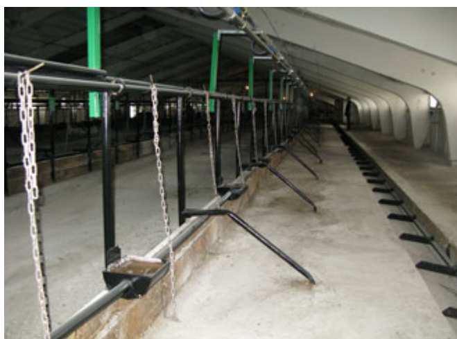
Рис.1. Скребковая система навозоудаления
