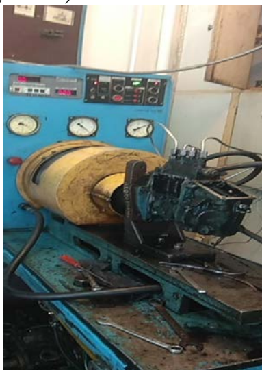
Рис. 1. Топливный стенд ДД 10-01 с установленным насосом УТН-5
