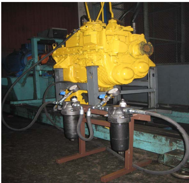
Рис. 5. Внешний вид установки для циркуляционной очистки и гомогенизации рабочей жидкости при обкатке ГКПП
