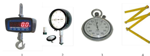
Рис. 5. Приборы, применяемые при экспериментальных исследованиях: 1 – весы крановые ВСК (0-1000 кг); 2 – тахометр часовой ТЧ-10Р; 3 – секундомер механический; 4 – линейка измерительная складная
