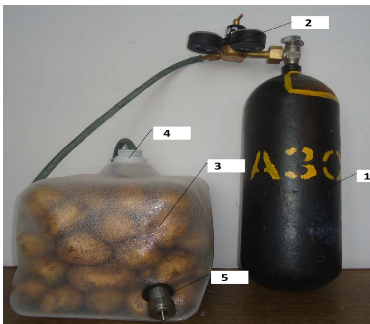
Рис. 1. Регулирование газовой среды при хранении картофеля в полиэтиленовой емкости:
